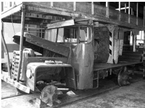
Zorra para el mantenimiento en túneles.
