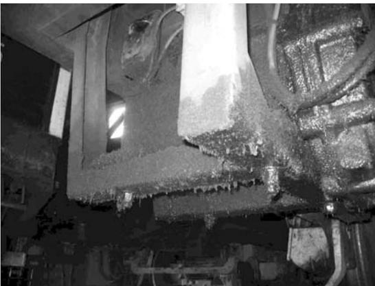
Se evidencia la falta de mantenimiento en las formaciones. Compresor coche -Línea A-.
